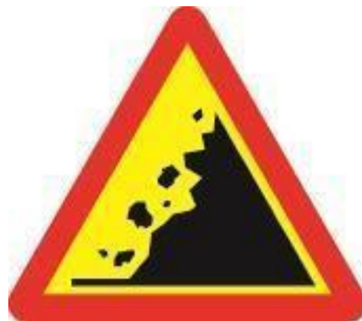
Biển số W.228 (a, b) “Đá lở” và Biển số W.228c “Sỏi đá bắn lên” và Biển số W.228d “Nền đường yếu”
