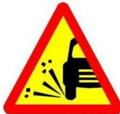
Biển số W.228 (a, b) “Đá lở” và Biển số W.228c “Sỏi đá bắn lên” và Biển số W.228d “Nền đường yếu”
